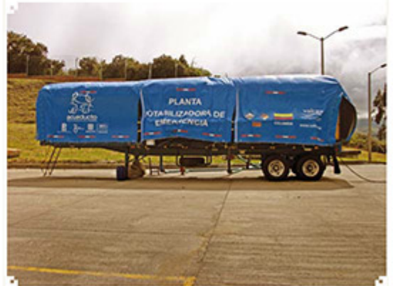
Figura 27. Planta de tratamiento móvil de agua subterránea o a fio de agua. Para casos de emergencia. Capacidad 10 l/seg. Aprox 1000 l/h.
